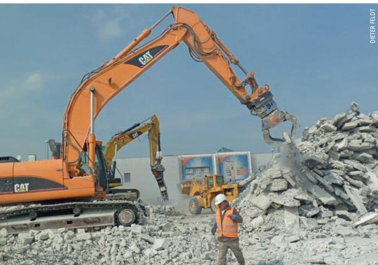
Einsatz in Augsburg: ASG-Abbruchsortiergreifer der Serie PMG 15 (Vordergrund) und Krokodilbeißer FR 20 von Trevi Benne.
