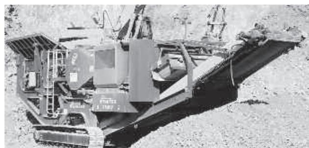
Zur Abdeckung von Leistungsspitzen im Steinbruch in Katzenelnbogen wurde ein Backenbrecher Fintec 1107 von OF-Mietpark eingesetzt. Foto: Oppermann & Fuss
