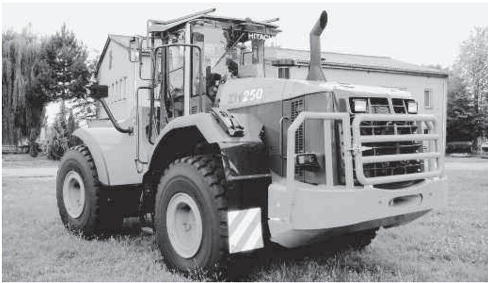
Das „Waste-handling“-Paket der Hitachi-Zaxis-Radlader bietet umfangreichen Schutz für Fahrer und Technik im harten Recyclingbetrieb. Foto: Kiesel/Hitachi
