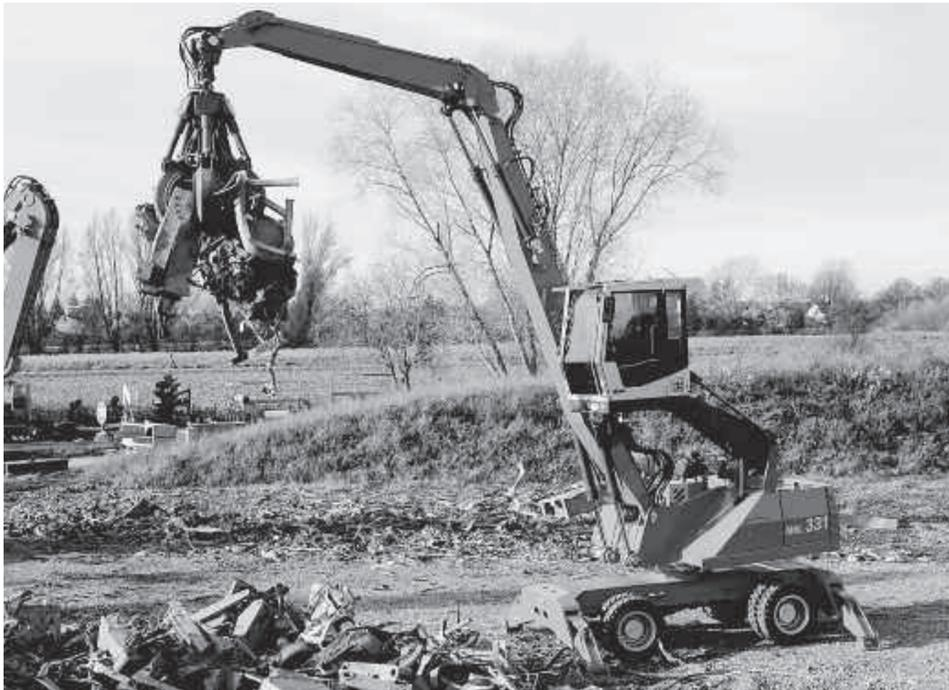
Kiesel präsentiert unter anderem den kompakten Terex Fuchs MHL 331 D. Er kommt dank größerem Unterwagen sowie verstärktem Ausleger und Schwenkwerk mit höheren Traglasten gut zurecht. Foto: Kiesel/Terex Fuchs
