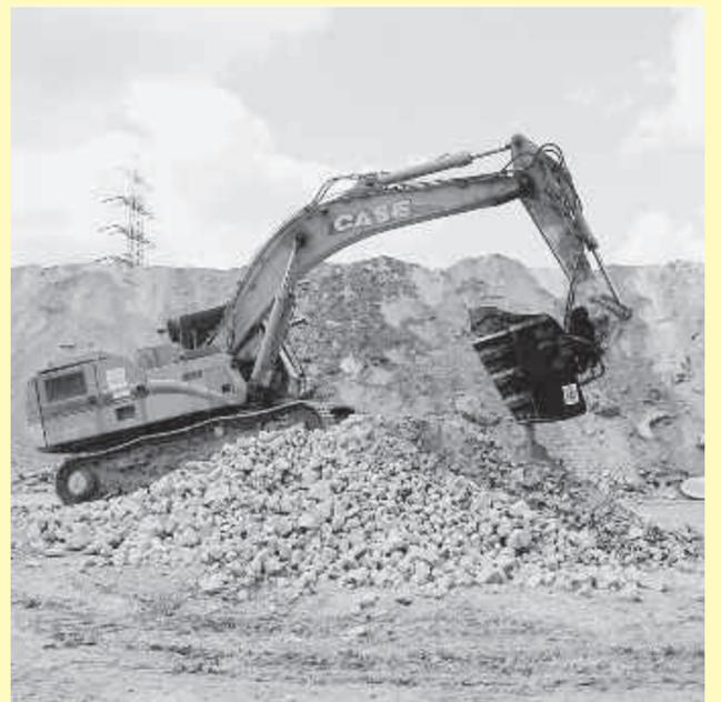
Ein Case 1288 mit einem BBL BF 90 bei der Aufbereitung von Schlacke. Foto: SAT
