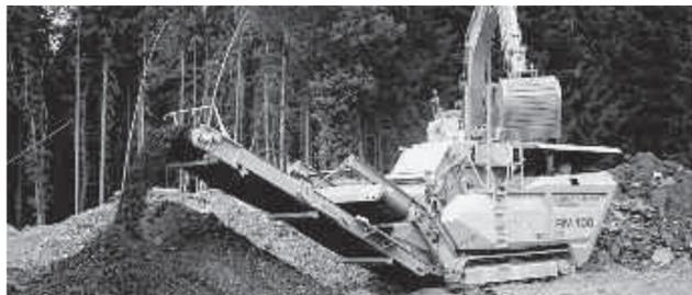
Die raupenmobilen Brecher wie der präsentierte RM100 sind im Nu betriebsbereit und können von nur einer Person bedient werden – dank Funkfernsteuerung für Brech- und Fahrbetrieb.
