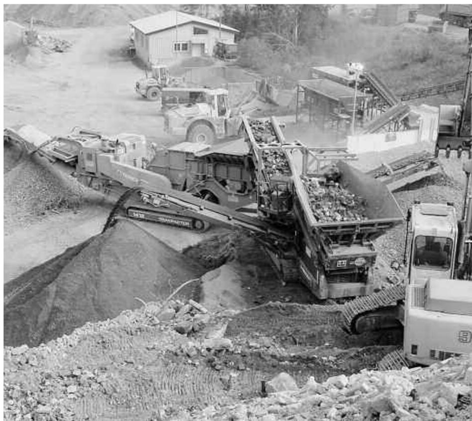
Der Terex Pegson Trakpactor 1412 überzeugte durch eine Vielzahl von Vorteilen. Der verbaute Hazemag-EPR-Prallbrecher mit seinen hydraulisch abgestützten Prallwerken verarbeitet selbst dicke Brocken mit hoher Leistung bei gut abgestuftem Endkorn mit geringem Überkornanteil. Der im Drehmoment gedrosselte Cat-C13-Dieselmotor gestattet eine stufenlose Drehzahlregulierung ohne Leistungsverluste. Foto: Christophel
